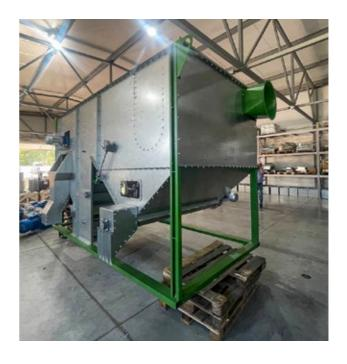
Сепаратор предназначен для предварительной очистки зерновых, зернобобовых, мелкосеменных и др. культур перед сушкой.
